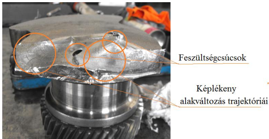
1.ábra: A letört tengelyvég tört felülete
