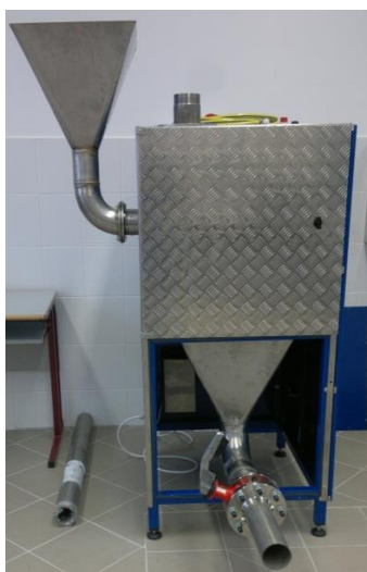
5. ábra Shark nyírótechnológiával működő vizes aprító berendezés
