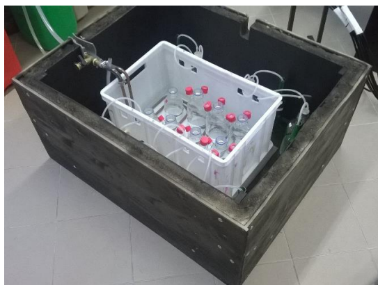
3. ábra Szigetelt faladában elhelyezett vízfürdő temperálású bioreaktor-blokk és keverőrendszere
